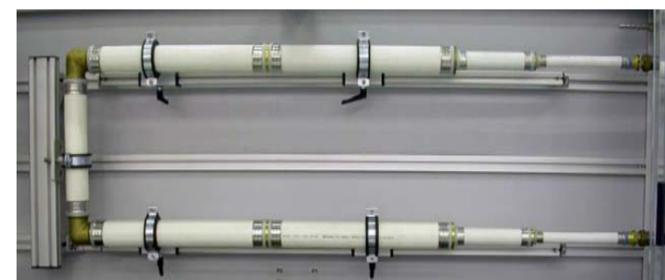
**LINEA DI MISURA PORTATA CON CALCOLO DEL KV CON IMPIANTO REALIZZATO A NORME, ATTACCHI A BOCCHETTONE, PRESE DI PRESSIONE ANULARI CON TRASDUTTORI DI PRECISIONE POSIZIONATI ALL'INTERNO DEL BANCO E COLLEGATI CON TUBAZIONI FLESSIBILI, POSSIBILITA' DI ESEGUIRE MISURE SU COMPONENTI CON FLUSSO ASSIALE OPPURE A  $90^\circ$**
