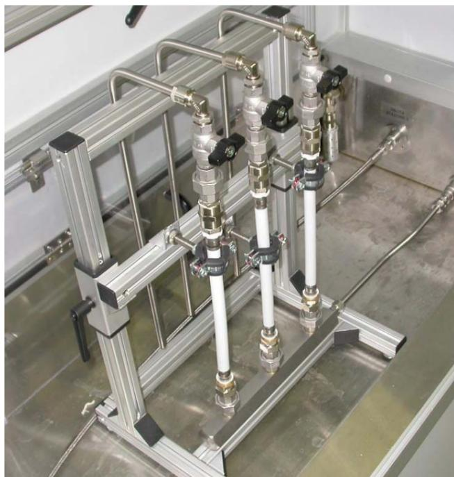
**STAZIONE DI PROVA CICLI TERMICI CON SUPPORTI MOBILI E COLLARI DI FISSAGGIO, STAFFA DI BLOCCAGGIO POSTA ALL' ESTREMITA' SINISTRA PER MANTENERE IN TRAZIONE IL TUBO DURANTE TUTTO IL CICLO.**
