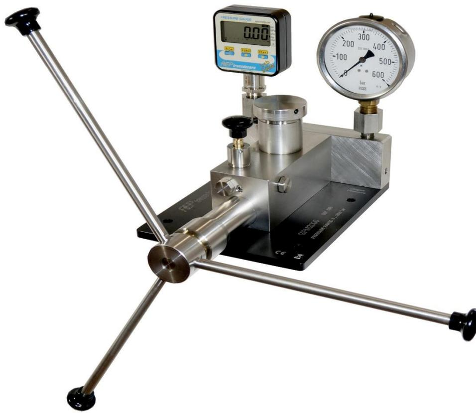
Le pompe della serie **BT** sono un semplice sistema che permette di assolvere ai problemi di taratura, conferma metrologica e controllo di manometri digitale e ad indice, trasduttori, trasmettitori di pressione e pressostati con un campione di prima linea munito della certificazione ACCREDIA.
