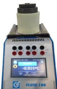
I Fluid con il diametro del pozzetto di 60mm possono essere corredati di un tubo d'estensione per aumentare l'immersione totale a 230 mm
