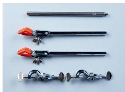
Kit supporti per il fissaggio delle sonde in prova.
