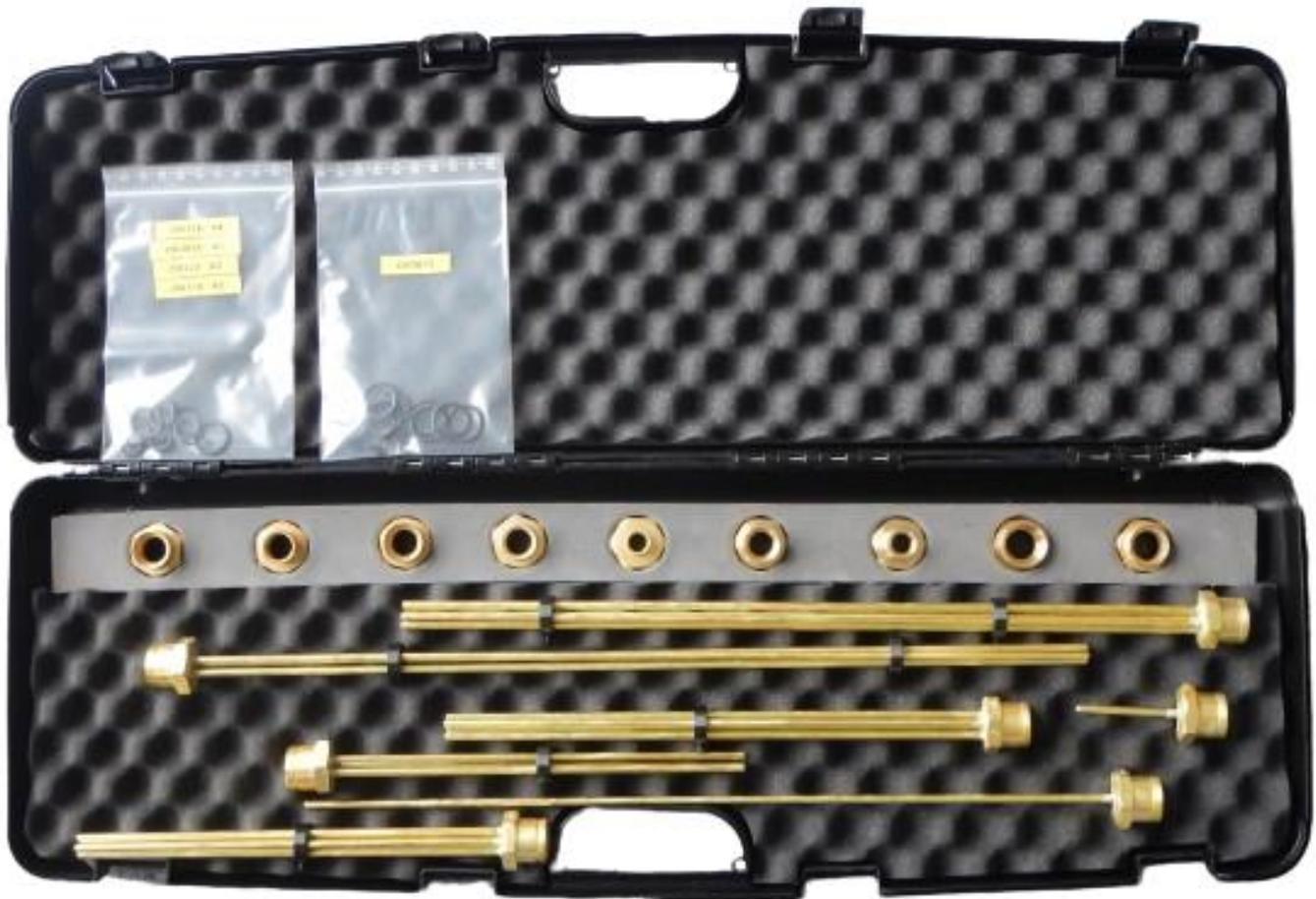
Resistenze idrauliche tubolari a flusso calibrato per misure di portata e di rumore di rubinetteria idrosanitaria
