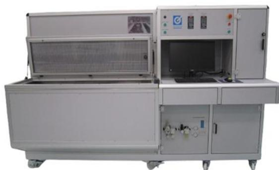
Sono disponibili modelli con camera di prova orizzontale con dimensioni in lunghezza 800 mm sino a 1.600 mm (vedi sopra), oppure con camera di prova verticale con altezza sino a 1.600 mm (vedi a lato).
