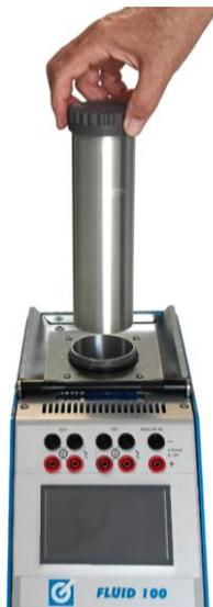
5. In caso di necessità di sostituzione dell'olio estrarre l'inserto manualmente.
