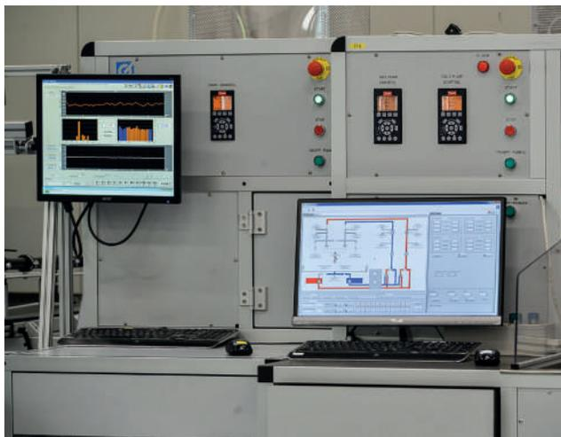
I banchi prova Giussani sono realizzati per testare e collaudare rubinetteria idrosanitaria e componenti idraulici.
